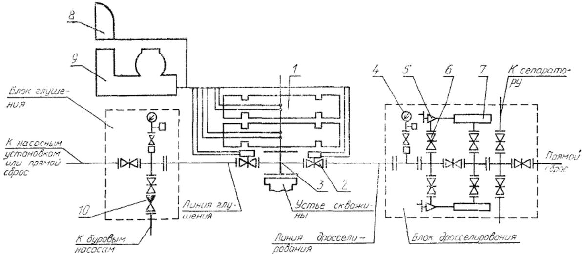
1 - плащечный превентор; 2 - задвижка с гидравлическим управлением; 3 - устьевая крестовина; 4 - манометр с запорным и разрядным устройствами и разделителем сред; 5 - дроссель регулируемый с ручным управлением; 6 - задвижка с ручным управлением; 7 - гаситель потока; 8 - вспомогательный пульт; 9 - станция гидравлического управления; 10 - обратный клапан
