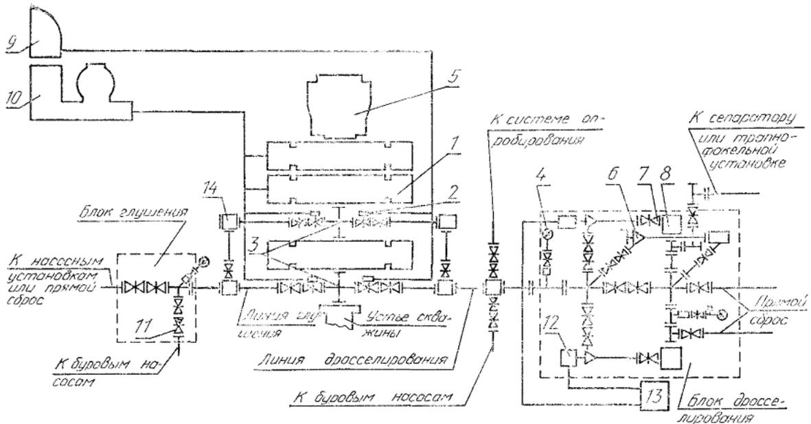
1 - плащечный превентор; 2 - задвижка с гидравлическим управлением; 3 - устьевая крестовина; 4 - манометр с
