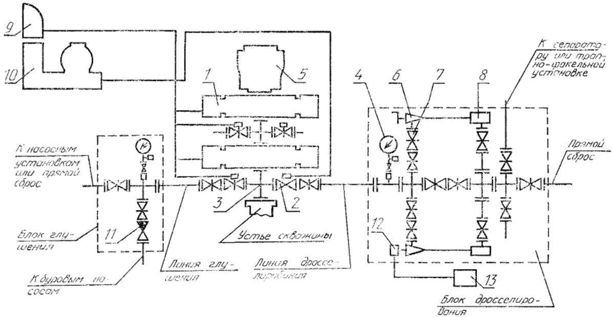
1 - плащечный превентор; 2 - задвижка с гидравлическим управлением; 3 - устьевая крестовина; 4 - манометр с запорным и разрядным устройствами и разделителем сред; 5 - кольцевой превентор; 6 - дроссель с ручным управлением; 7 - задвижка с ручным управлением; 8 - гаситель потока; 9 - вспомогательный пульт; 10 - станция гидропривода; 11 - обратный клапан; 12 - регулируемый дроссель с гидравлическим управлением; 13 - пульт управления гидроприводным дросселем
