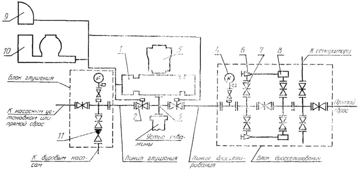
1 - плащечный превентор; 2 - задвижка с гидравлическим управлением; 3 - устьевая крестовина; 4 - манометр с запорным и разрядным устройствами; 5 - кольцевой превентор; 6 - дроссель регулируемый с ручным управлением; 7 - задвижка с ручным управлением; 8 - гаситель потока; 9 - вспомогательный пульт; 10 - станция гидропровода; 11 - обратный клапан
