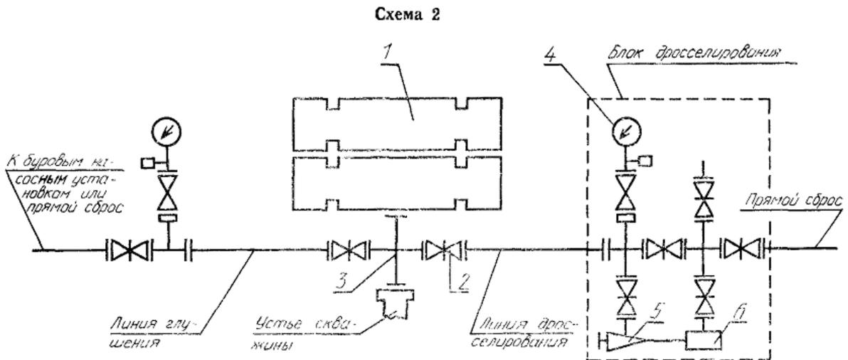
1 - плащечный превентор; 2 - задвижка с ручным управлением; 3 - устьевая крестовина; 4 - манометр с запорным и разрядным устройствами с разделителем сред; 5 - регулируемый дроссель с ручным управлением; 6 - гаситель потока
